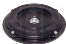
DISCO EMBRAIAGEM COMPRESSOR AC 64506901781
