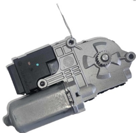
MOTOR TETO DE ABRIR
