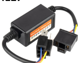
RESISTENCIA CANBUS H7 3W 120ohm
